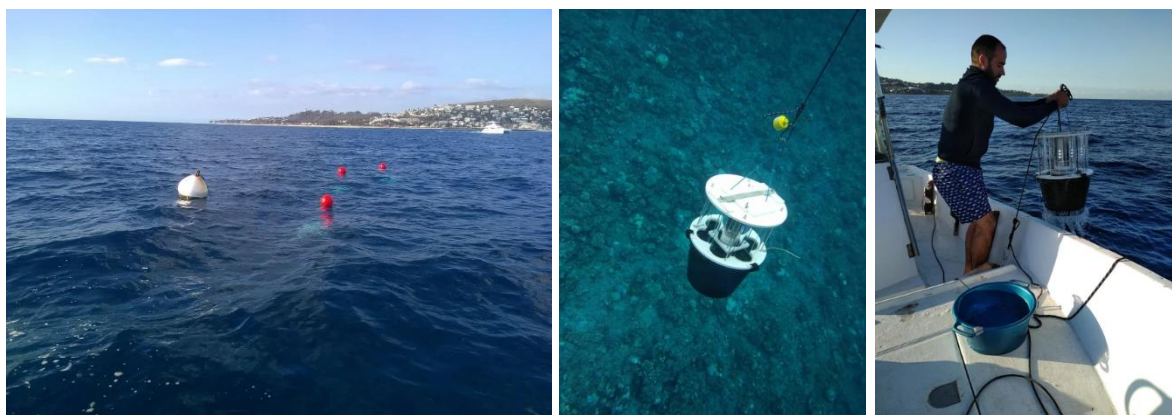
Figure 1 : Les pièges lumineux SAKITRAP utilisés lors du projet TRAPALI ; à gauche, la bouée de mouillage (blanche) à laquelle sont fixés trois pièges lumineux (flotteurs rouges) ; au centre, le piège tel qu'il se présente en position de captage sous l'eau ; à droite, la remontée d'un piège avec le panier de stockage des larves (images OCEA Consult')
