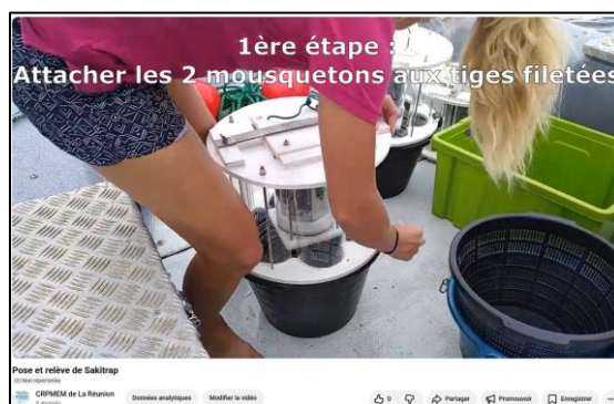
Figure 7 : Capture d'écran de la vidéo de présentation détaillée des procédures de manipulation des SAKITRAP et de récupération des larves capturées (lien : https://youtu.be/PCvG2_6BruM ), qui servira de support à la formation des pêcheurs mobilisés sur le projet TRAPALI
